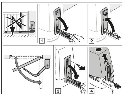
Under et strømsvigt skal anlægget åbnes og lukkes manuelt. Lågeåbneren skal frakobles.
